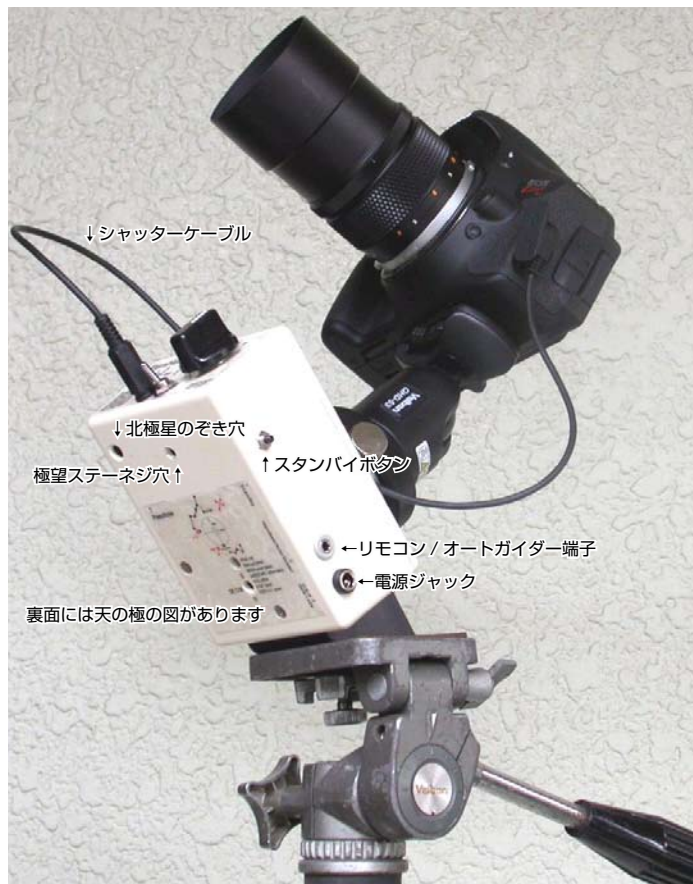
撮影のスタイル。PanHead EQ PH-1は下部に35度傾斜のウエッジが標準装備です。このため、三脚の雲台を使用しないで、直接三脚に装着することもできます。
