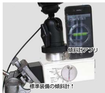
PanHead EQ の西側面には円盤の傾斜計が付いています。0.3 度 (20') は読みとれます。円盤の代わりに文房具の大ききな分度器（ユーザーが用意）も下げられます。写真のようにスマートフォンのアプリにある傾斜計や方位磁石（偏角自動補正が多い）も便利です。
