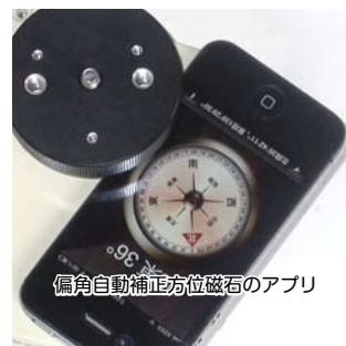
PanHead EQ の西側面には円盤の傾斜計が付いています。0.3 度 (20') は読みとれます。円盤の代わりに文房具の大ききな分度器（ユーザーが用意）も下げられます。写真のようにスマートフォンのアプリにある傾斜計や方位磁石（偏角自動補正が多い）も便利です。
